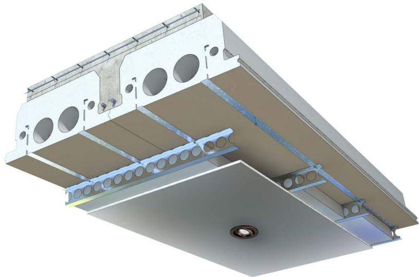
*Aislamiento EPS adicional debajo de Quad-Deck utilizando canales en Z perpendiculares y, a continuación, paneles de yeso.*
