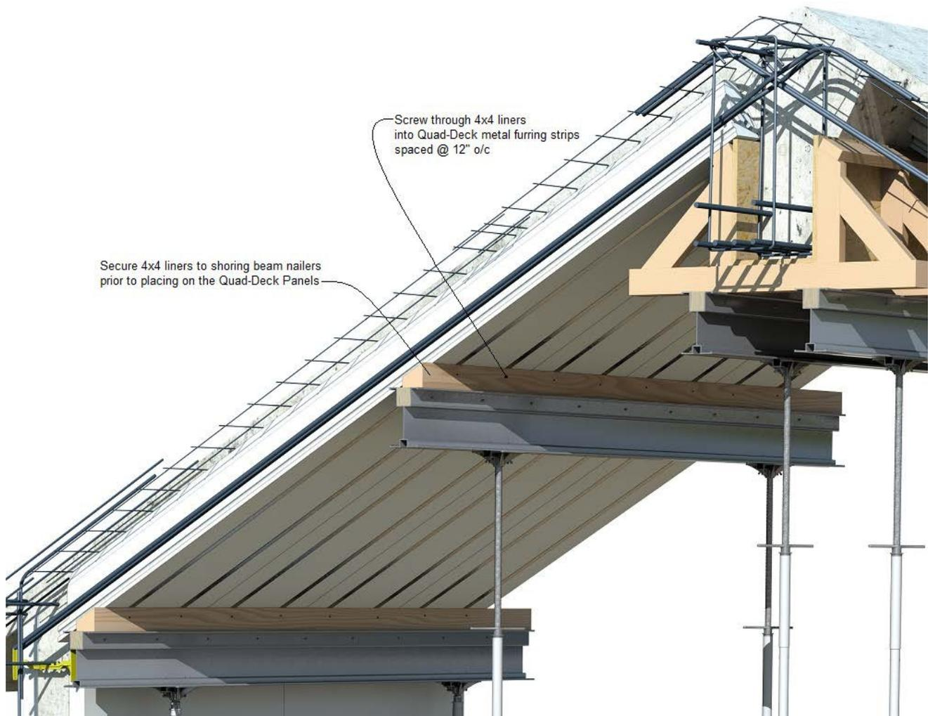
**NOTA:** No pise las cavidades de las viguetas. Están diseñadas para soportar las barras de refuerzo y el hormigón, pero no el peso de una persona. Repare las alas del panel dañadas como se ha descrito anteriormente.
